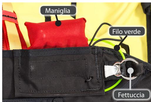
Figura 41 - Componenti Sistema di svincolo dall'alto
