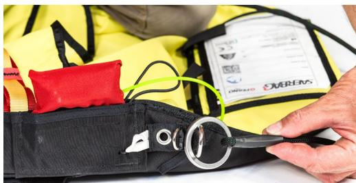
Figura 42 - Posizionamento connettore tra i due anelli
