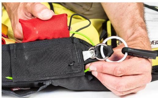
**Figura 48 - Sistema di svincolo dall'alto correttamente preparato**
