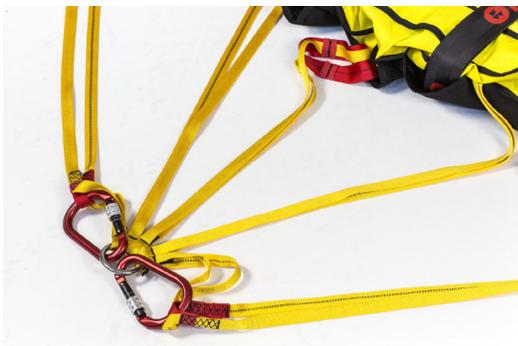
**Figura 31 - Connettori collegati alle asole e all'anello centrale**
