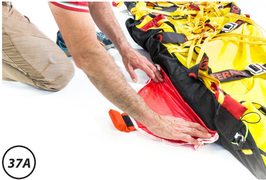
Abbildung 37 - Fertigstellung Verstauen des Segels in der Hülle
