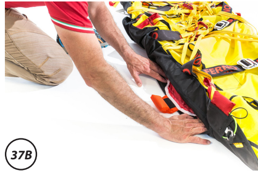
Abbildung 37 - Fertigstellung Verstauen des Segels in der Hülle
