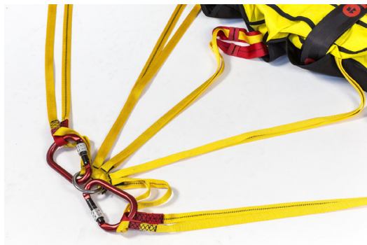
Abbildung 31 - Die Verbindungshaken sind an die Ösen und den zentralen Ring angeschlossen
