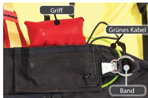
Abbildung 41 - Komponenten des Systems zum Auslösen von oben
