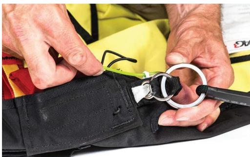
**Abbildung 46 - Einführen des grünen Kabels in die Schlaufe**
