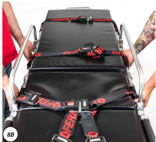
Figura 8 - A: NON CORRETTO sollevamento della barella B: CORRETTO sollevamento della barella impugnando il telaio principale
