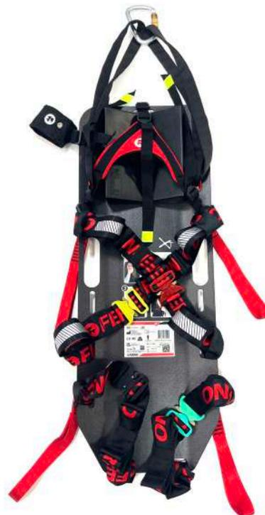
**Figura 37 - Posizionamento delle cinture inguinali**
