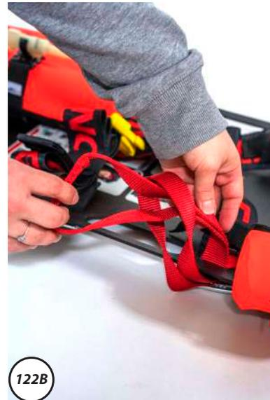
**Figura 122 - Fissaggio maniglie ausiliarie**
