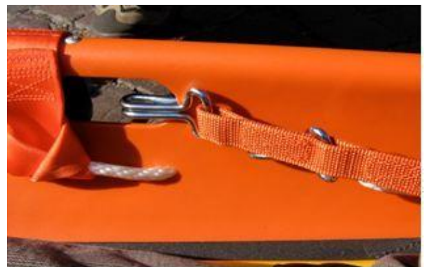
Abbildung 5 b - Verankerung des Gurts am Griff
