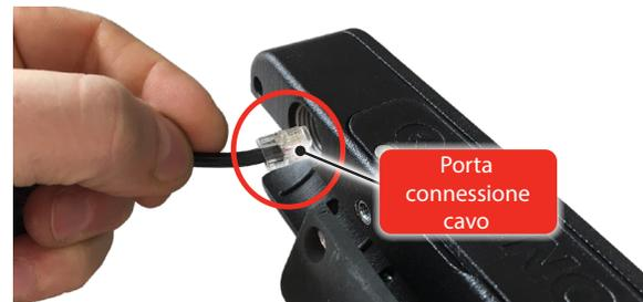
Figura 10 - Connessione del cavo al vano connettore
