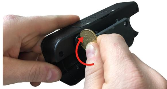
Figura 9 - Apertura vano connettore
