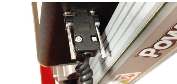
Figura 12 - Connessione cavo all'alloggiamento motore
