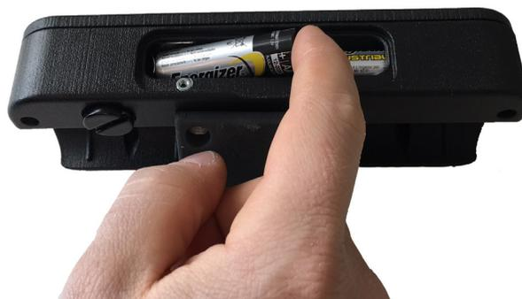
Figura 3 - Sostituzione Batterie
