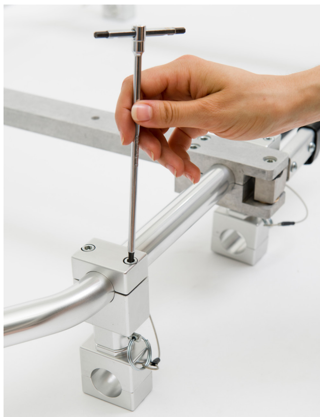
Figura 4: Montaggio blocchetto fisso su telaio ITC-HL.
