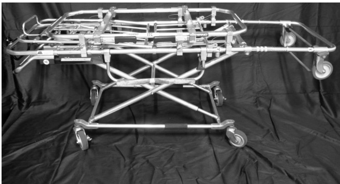
Figura 14: Installazione telaio ITC-HL su Barella Ferno 35A.
