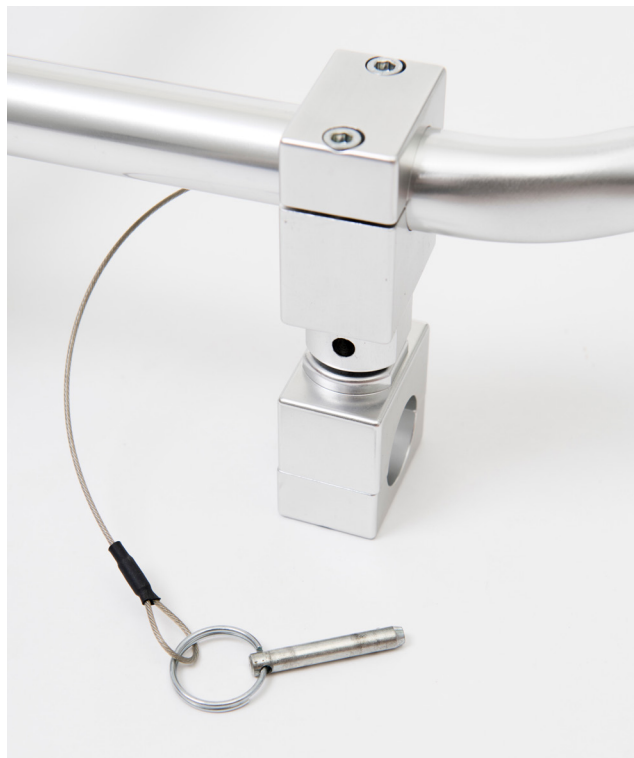
Figura 6 Particolare della spina di sicurezza da rimuovere quando si vuole separare il telaio ITC-HL dalla barella
