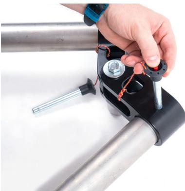
Halten Sie den Kopf an den Bohrungen der Beine fest und stecken Sie den Bolzen ein. In derselben Weise am anderen Bein vorgehen.
