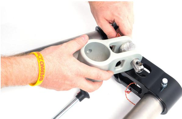
Stecken Sie den Bolzen in die Bohrung im grauen Kopf.
