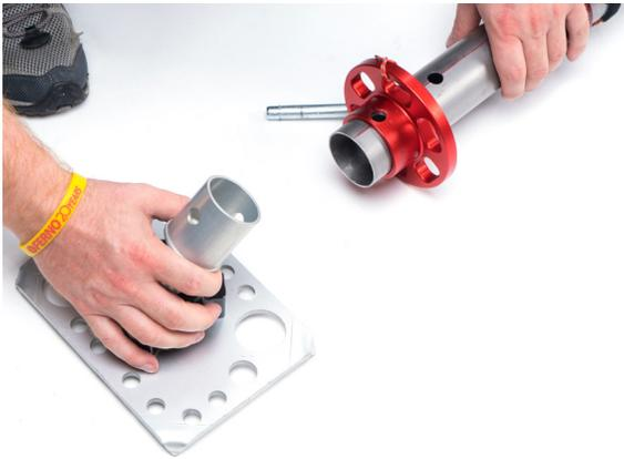
Stecken Sie den Kugelgelenkfuß am Ende des Beins ein. Das Kugelgelenk ermöglicht eine Anpassung des Eagle Nest 3 an die unterschiedlichen Beinwinkel.
