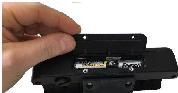
Figure 1 - Ouverture du compartiment des piles
