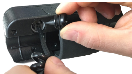
Figure 13 - Déconnexion du connecteur
