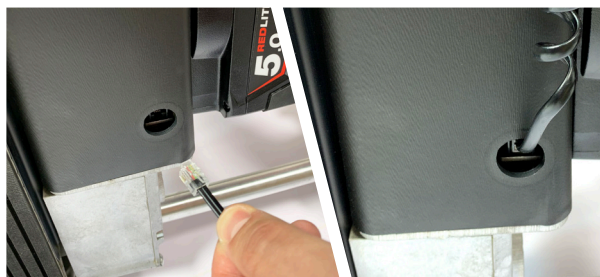
Figure 12 - Connexion du câble au logement du moteur
