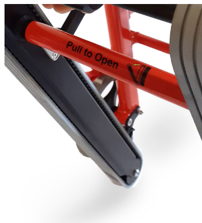
Ouvrir le chariot des courroies
