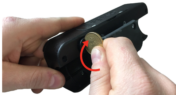
Figure 9 - Ouverture du logement du connecteur
