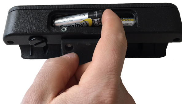
Figure 3 - Remplacement des piles
