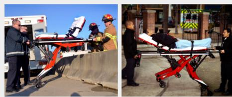
iNjX® est la seule civière avec un système x-frame avec jambes indépendantes. Cette caractéristique résulte gagnante pour franchir les obstacles avec facilité sans être obligés de soulever complètement la civière quand on rencontre par exemples des marches, des rails de sécurité etc... ce qui se passe au contraire avec d'autres civières électroniques.
