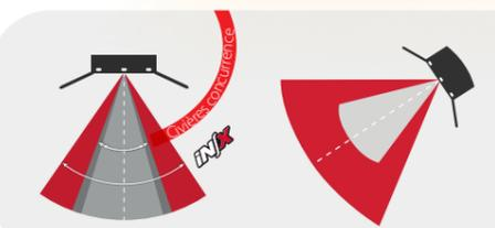
En tenant compte du fait qu'elle ne doit pas être accrochée à un système de chargement positionné à l'intérieur de l'ambulance, iNjX®, contrairement aux autres civières électroniques disponibles dans le commerce, peut être chargée en utilisant un angle plus ample et sans contraintes.
