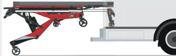
Grâce aux jambes motorisées indépendantes, iNjX® protège la sécurité et la santé de l'équipage en évitant à l'opérateur de supporter le poids lors du chargement et du déchargement.
