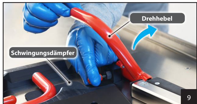
Anheben des Drehhebels
