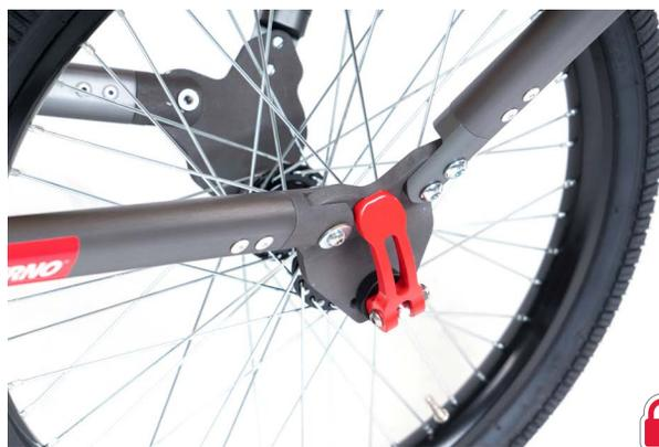
**Arrivati a fine filetto, chiudere in modo serrato la leva di bloccaggio nel caso non si chiuda completamente, svitare leggermente l'asse ruota.**
