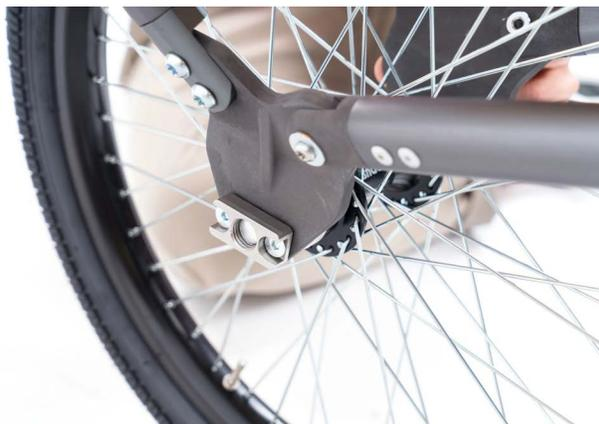
**Posizionare l'asse ruota con l'inserto filettato prendendo tutti e due i fori.**
