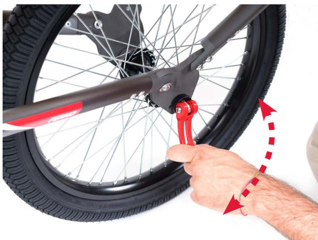
**Una volta inserito l'asse ruota, avvitarlo fino alla fine del filetto.**
