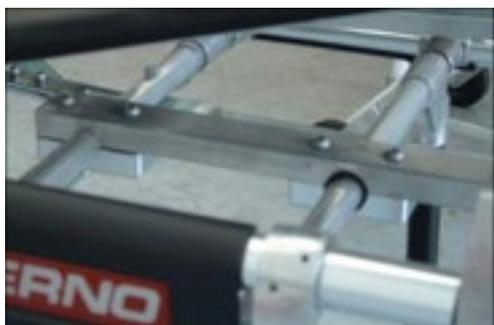
Figura 10: Dettaglio morsetti centrali e anteriori.
